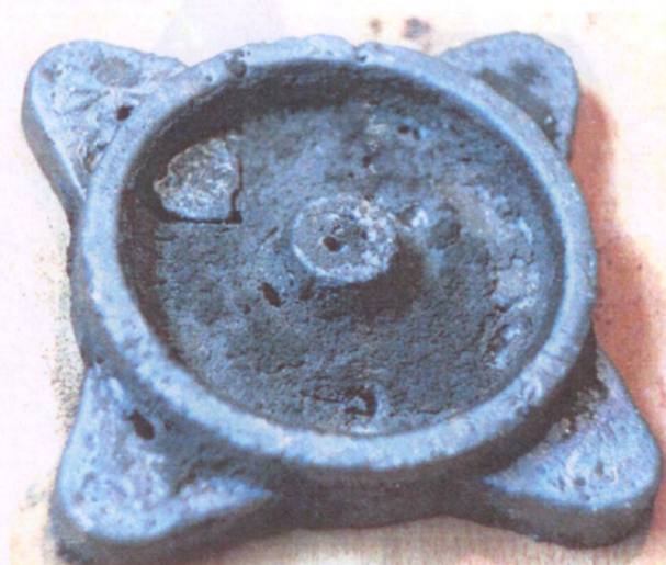
Рис. 38. Отливка «Фланец» с газовыми раковинами по верхней поверхности
