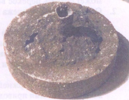
Рис. 8.6.2. Отливка «Колесо» с дефектом «Обвал»
