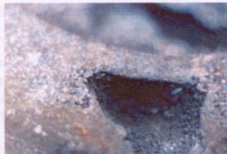
Рис. 8.6.6. Фрагмент отливки «Колесо» с земляной раковинкой от обвала (увеличено)
