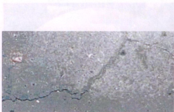
Рис. 466. Фрагмент отливки «Плита» с дефектом «Ужимина» (увеличено)
