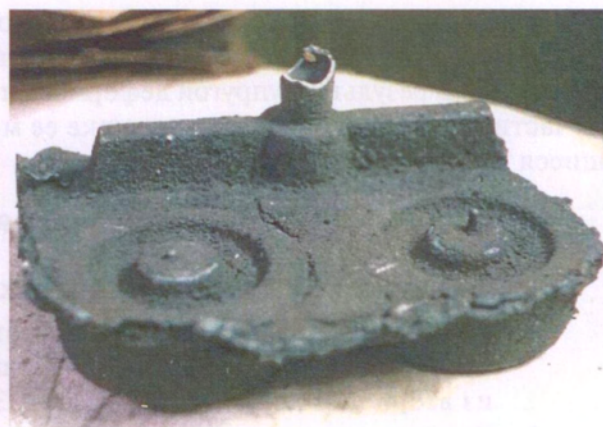
Рис. 8.1.6. Отливка «Каток» с заливом по разъему формы
