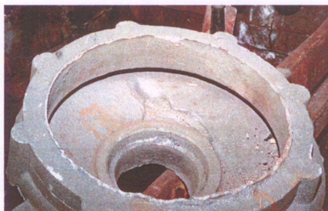
Рис. 7.2.7а. Отливка «Корпус вала» с ужиминами
