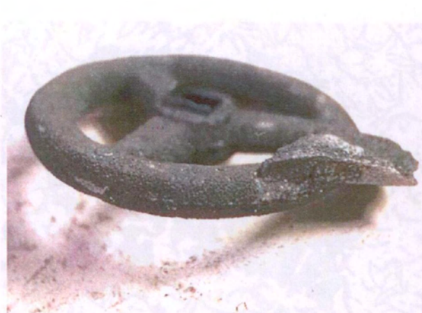
Рис. 8.7.10. Отливка «Маховик» с подрывом
