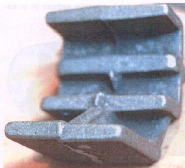
Рис. 42. Отливка «Кронштейн» со смещением половинок модели
