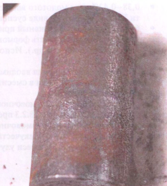
Рис. 8.2.3. Отливка «Стакан» с «распором»
