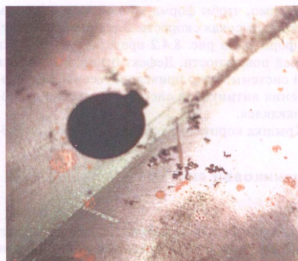
Рис. 8.4.3б. Дефект отливки (увеличено)
