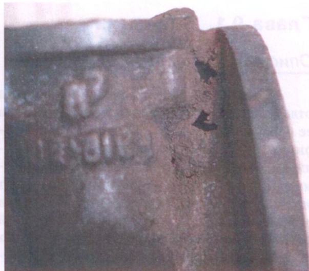
Рис. 8.7.11. Фрагмент отливки «Корпус вентиля» с дефектом «Подрыв»
