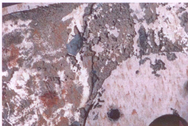
Рис. 7.2.5. Отливка «Плита» с ужинойой
