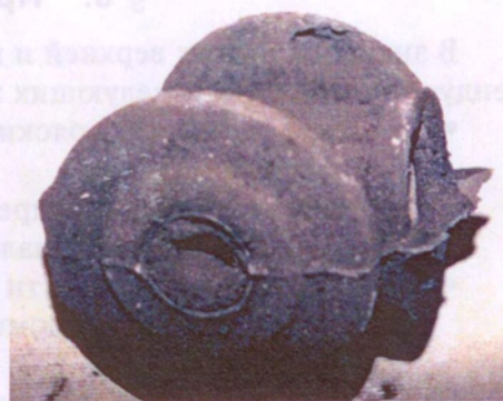
Рис. 8.5.5. Отливка «Корпус вентиля» с дефектом «Обжим» в виде земляной раковины и следами прилива от разрушения смеси
