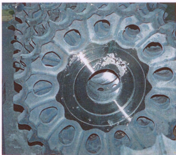
Рис. 8.4.13а. Отливка «Колесо ведущее» с земляной раковинной
