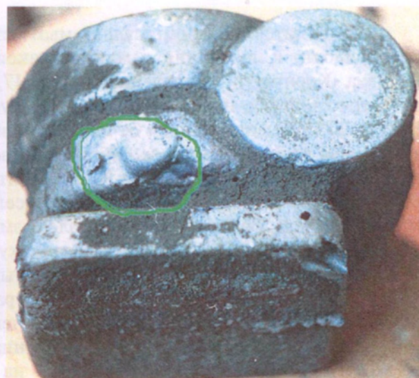
Рис. 32. Отливка «Корпус» с неспаем в верхней части отливки Дефект вызван повышенной газотворностью стержневой смеси и отсутствием вентиляции. После выполнения вентиляции из стержня дефект не возникал.
