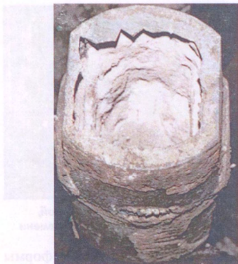
Рис. 43. Отливка «Ступица», показанная с не удалённым жидкостекольным стержнем, имеет разностенность из-за смещения стержня в знаке
