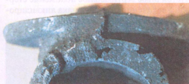
Рис. 49. Отливка «Переходник угловой» имеет земляные раковины, образовавшиеся в результате обжима формочной смеси стержневым знаком Увеличение размера формочного знака успешно ликвидировало дефект.
