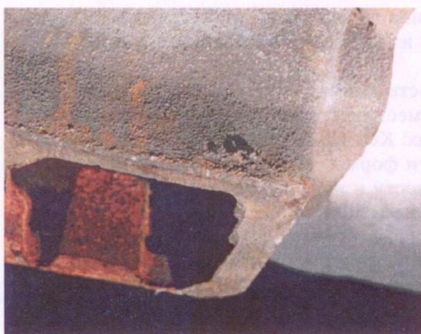
Рис. 8.4.5. Отливка «Корпус насоса» с дефектом «Размыв»
