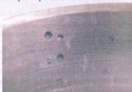
Рис. 29. Фрагмент фланца отливки «Корпус» со шлаковыми раковинами
