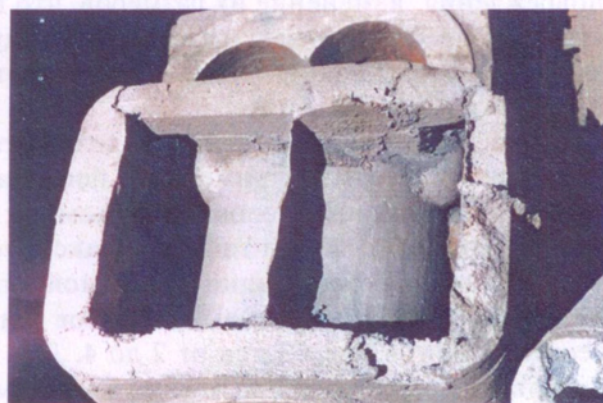
Рис. 8.3.5. Отливка «Корпус насоса с «задиrom»
