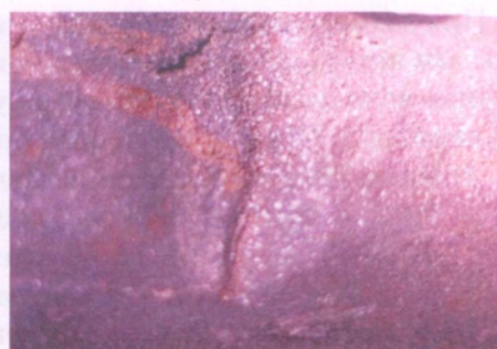
Рис. 7.2.6б. Фрагмент отливки с ужинойой (увеличено)
