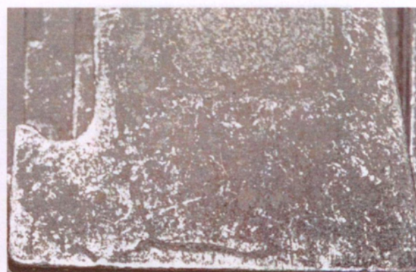
Рис. 47. Отливка «Стойка» с ужиминной, возникшей в результате увеличенного времени заливки перегретым металлом
