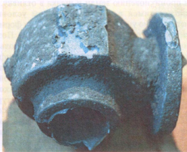
Рис. 34. Отливка «Корпус опорный» поражена газовой раковиной «Пузыри подкорковые» по фланцу и рабочей плоскости Дефект вызван отсутствием вентиляционной системы в стержне. После выполнения вентиляционного канала по оси стержня с выводом газа в атмосферу дефект не проявлялся.
