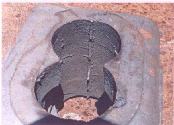
Рис. 8.1.4. Отливка «Корпус насоса» с заливом металла по разъему стержней
