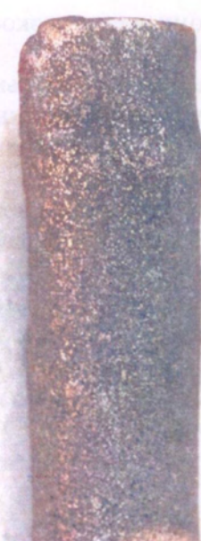
Рис. 8.2.1. Отливка «Вал» с «распором»
