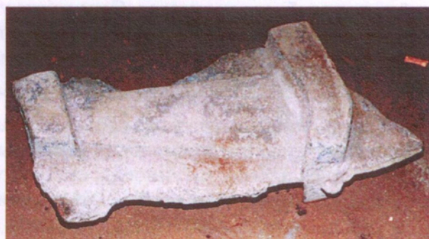
Рис. 8.7.13. Отливка «Било» с подрывом формовочной смеси
