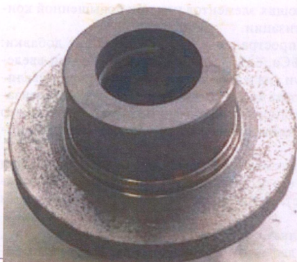
Рис. 9.2.2а. Отливка «Втулка» с дефектом «Отбел» на обработанной поверхности
