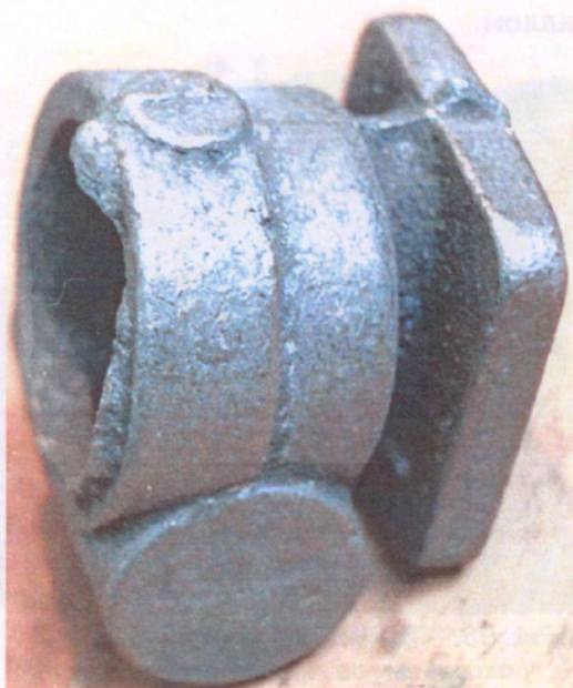
Рис. 41. Отливка «Корпус редуктора» с подрывом знаковой части формы при извлечении модели
