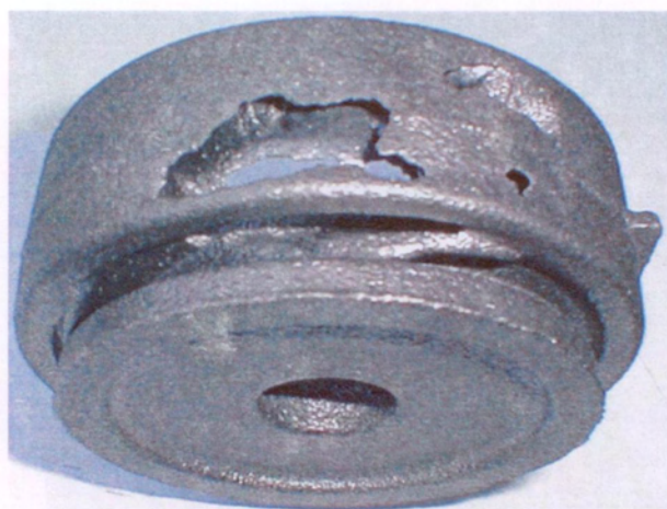
Рис. 5. Отливка рабочего органа 5 со светлой, гладкой газовой раковиной
