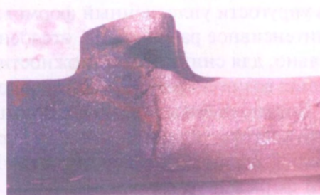
Рис. 7.2.6а. Отливка «Коллектор» с ужинойой
