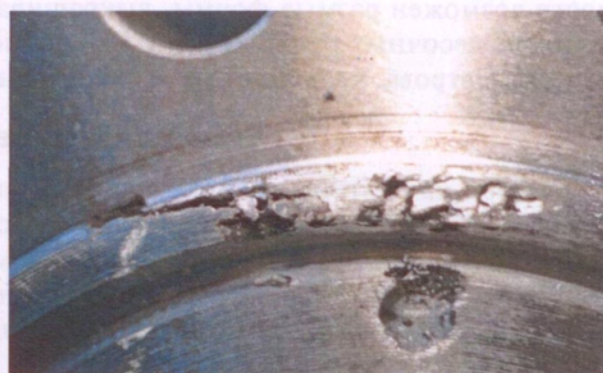
Рис. 8.4.8. Фрагмент фланца отливки «Корпус вентиля» с земляной раковинной по уплотняющему бурту
