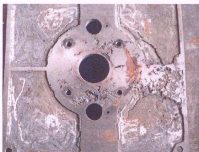
Рис. 7.2.2. Отливка «Крышка стола» с ужинойой
