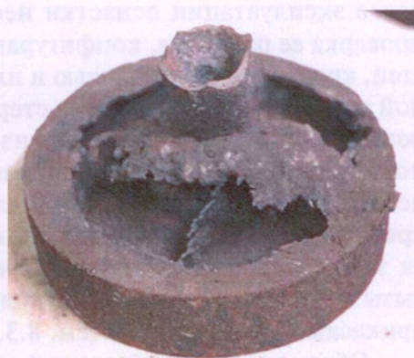
Рис. 8.6.5. Отливка «Колесо» с обвалом части болвана
