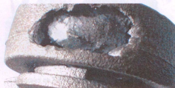
Рис. 4а. Отливка рабочего органа 4 с окисленной газовой раковиной «пузырь подкорковый»
