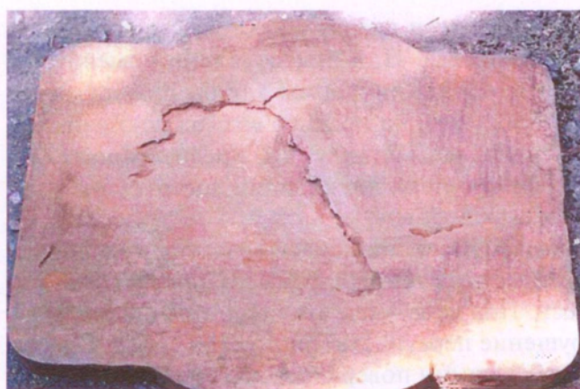
Рис. 7.2.4. Отливка «Опорный стол» с ужинойой
