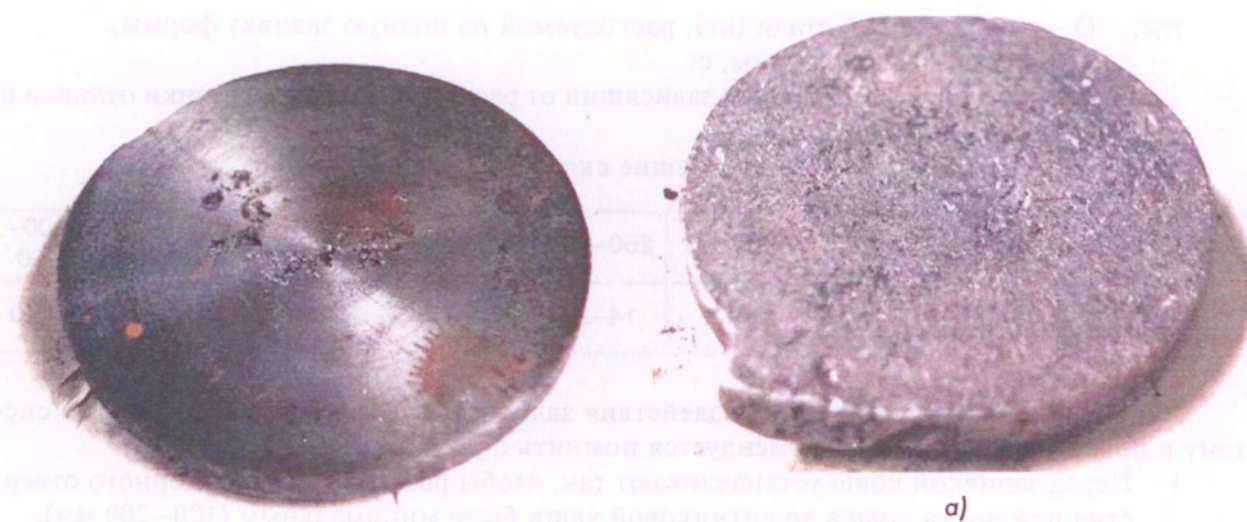
Рис. 8.4.2. Отливка «Крышка» с земляной раковинной от «размыва»
