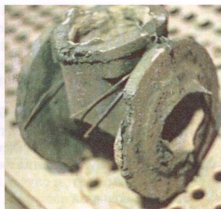
Рис. 8.6.3. Отливка «Корпус вентиля» с обвалом знаковой части формы
