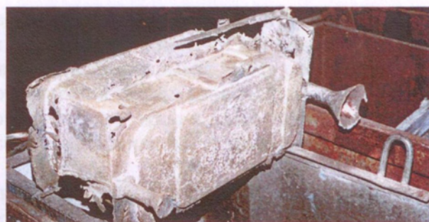
Рис. 8.1.3а. Отливка «Корпус» с заливками в спаривающихся частях стержней и формы
