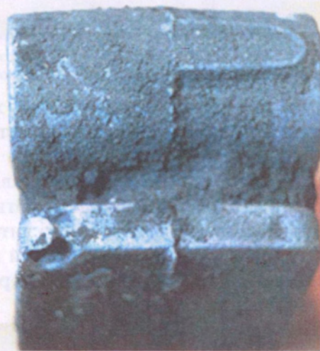
Рис. 33. Отливка «Корпус редуктора» с газовой раковиной на опорном фланце Дефект вызван низкой газопроницаемостью формовочной смеси и повышенной газотворностью стержня. Для ликвидации дефекта на поверхности формы выполнены вентиляционные наколы диаметром 5 мм в количестве 6 шт. на \text{дм}^2 и в стержне выполнен сквозной вентиляционный канал.
