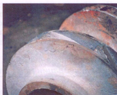
Рис. 7.2.3а. Отливка «Колесо рабочее» с ужинойой
