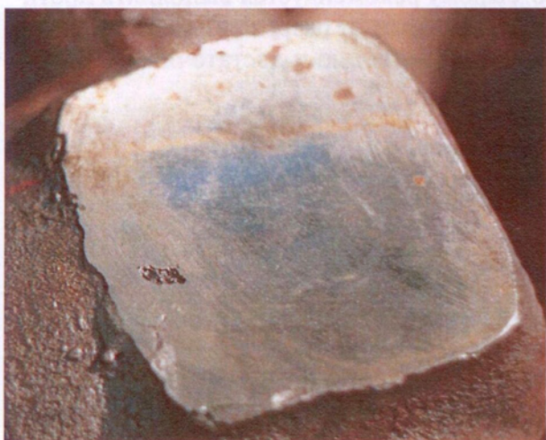
Рис. 8.4.16а. Рабочая площадка отливки «Корпус запорный» с земляной раковинной
