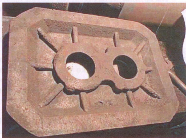
Рис. 7.3.1. Отливка «Крышка» с дефектом «Складчатость»
