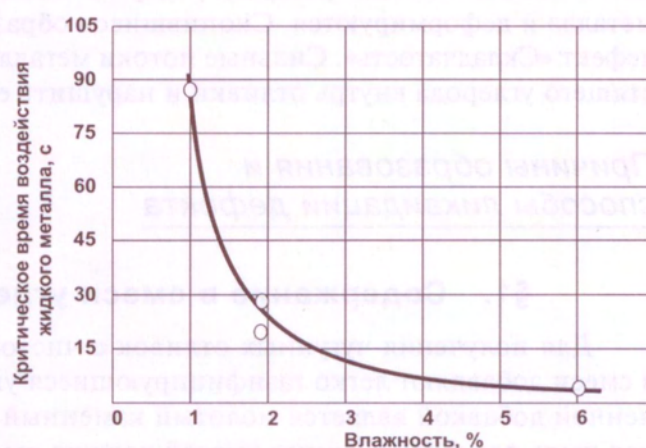
Рис. 7.2.10. Зависимость времени образования ужимин от суммарного содержания влаги в формовочной смеси
