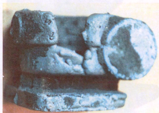
Рис. 37. Отливка «Корпус редуктора» с недоливом верхней части вследствие заливки охлаждённого металла и отсутствия хорошей вентиляции стержня
