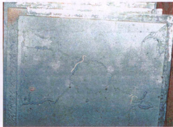
Рис. 46а. Отливка «Плита» имеет сеть ужимин, возникших в результате переуплотнения формовочной смеси с повышенной влажностью
