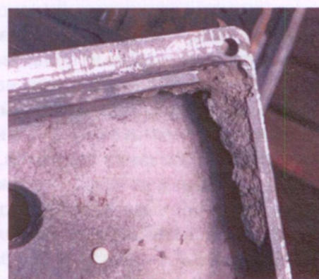
Рис. 8.7.9. Фрагмент отливки «Крышка стола» с дефектом «Подрыв»
