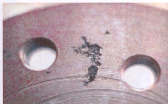
Рис. 27. Фланец отливки «Корпус» с земляной раковиной
