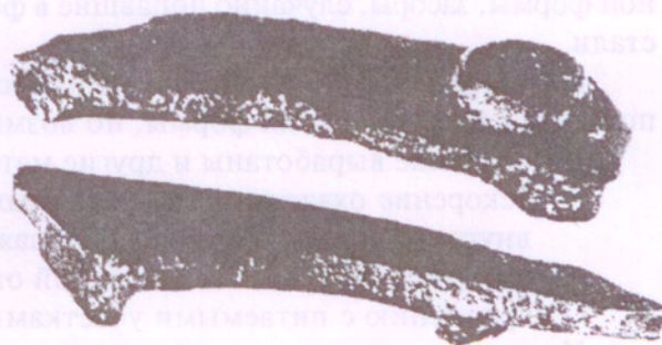
Рис. 9.2.1. Фрагменты стенок отливки с дефектом «Отбел»
