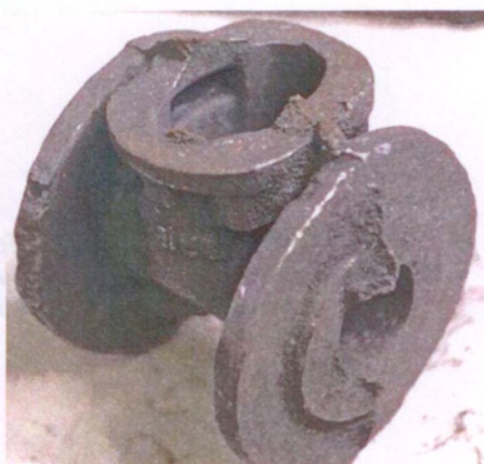
Рис. 8.5.2. Отливка «Корпус вентиля» с обжимом
