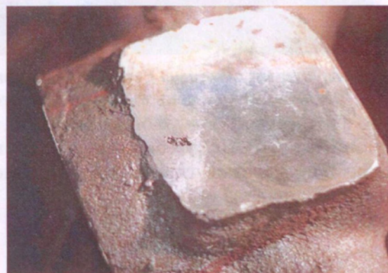
Рис. 28. Фрагмент отливки «Корпус» с земляной раковиной на рабочей поверхности
