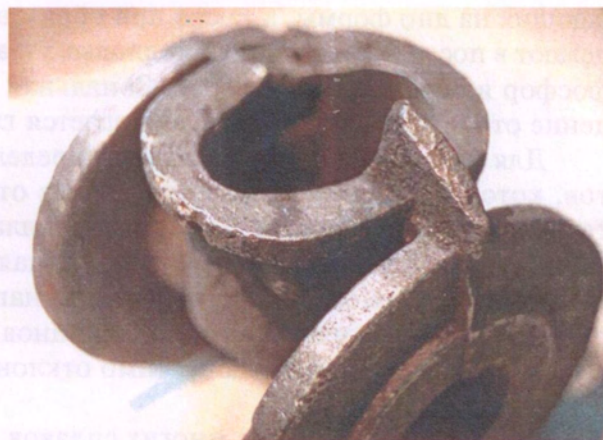
Рис. 8.7.12. Отливка «Корпус вентиля» с дефектом «Подрыв»
