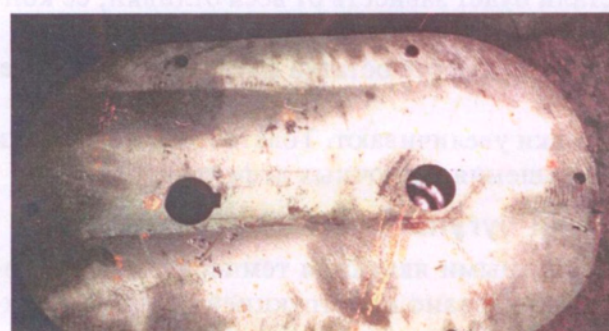
Рис. 8.4.3а. Отливка «Крышка корпуса» с земляной раковинной
