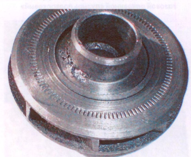
Рис. 9. Отливка рабочего органа 7 с окисленной, шероховатой раковиной в месте соединения стенок
