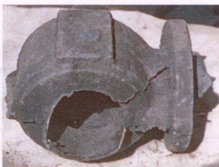
Рис. 8.5.3. Отливка «Корпус вентиля» с обжимом верхней полуформы
