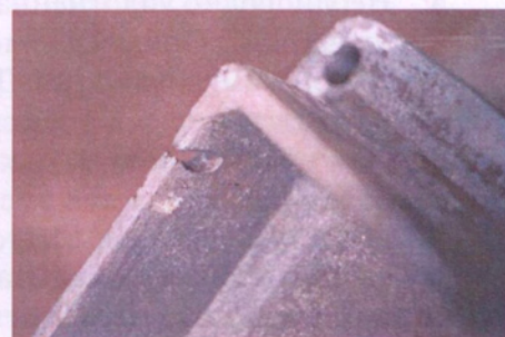
Рис. 8.7.3. Фрагмент отливки «Крышка стола» с песчаными раковинами
