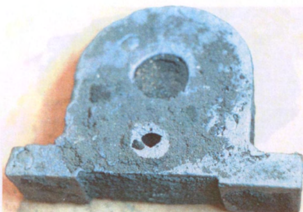
Рис. 39. Отливка «Опора» изготавливалась из смеси с повышенной влажностью, аналогичной используемой в примере на рис. 38
