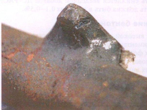
Рис. 8.4.7. Отливка «Патрубок всасывающий» с дефектом «Размыв»
