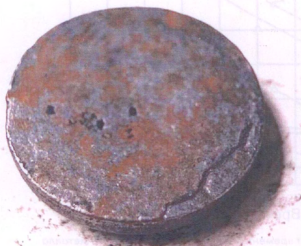
Рис. 7.2.8. Отливка «Фланец» с ужиной
