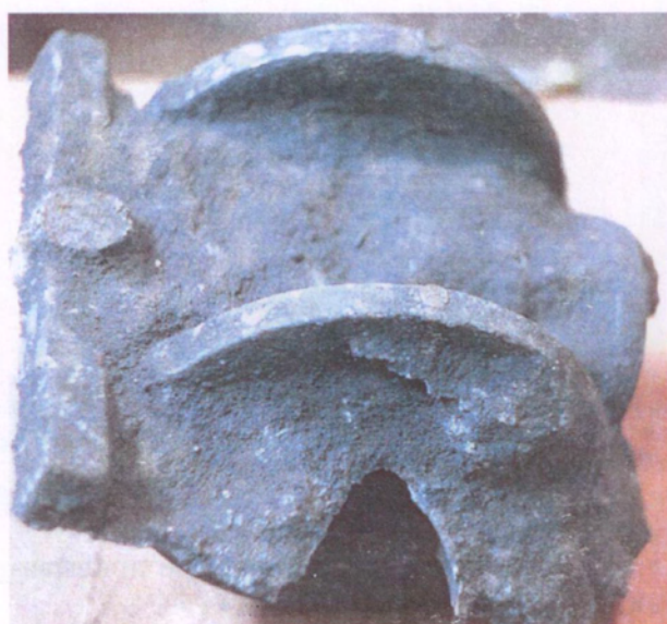
Рис. 35. Отливка «Корпус вентиля» с дефектом «Обвал»
