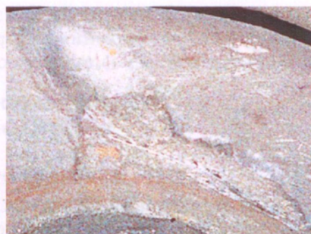
Рис. 7.2.7б. Фрагмент отливки с дефектом (увеличено)
