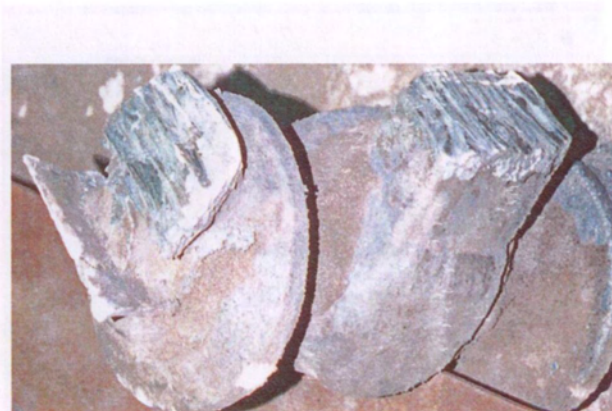
Рис. 18. Отливка «Корпус» с отрезанными прибылями
