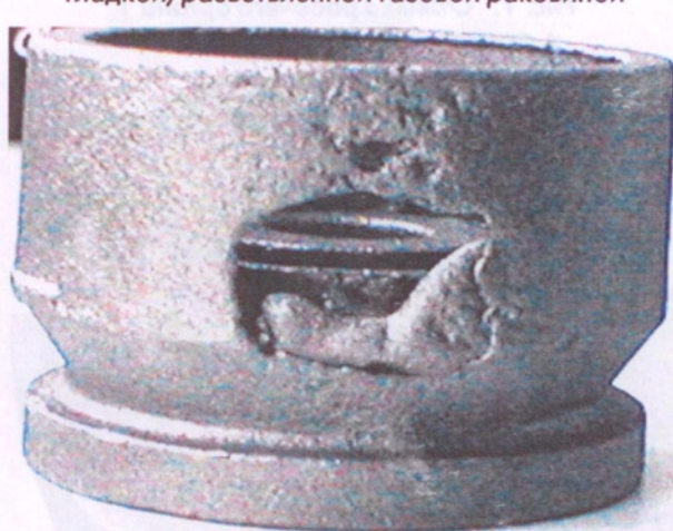
Рис. 8. Отливка рабочего органа 8 со светлой, гладкой, локальной газовой раковиной
