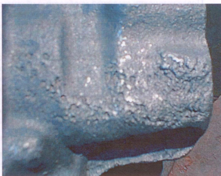
Рис. 8.4.1. Фрагмент отливки «Корпус» с песчаными раковинами в результате размыва формы
