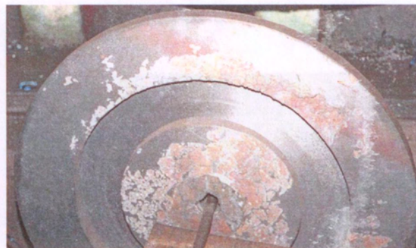
Рис. 44. Отливка «Колесо» имеет земляные раковины, возникшие вследствие уменьшенного припуска на механическую обработку
