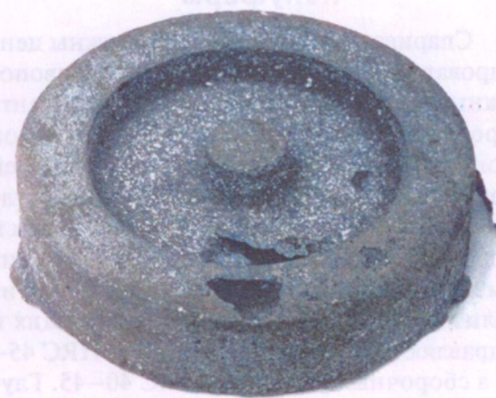
Рис. 8.6.1. Дефект отливки «Обвал»
