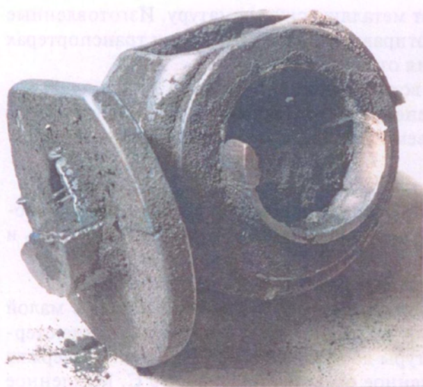
Рис. 8.1.2. Отливка «Корпус вентиля» с заливками в зазоры между знаками формы и стержня
