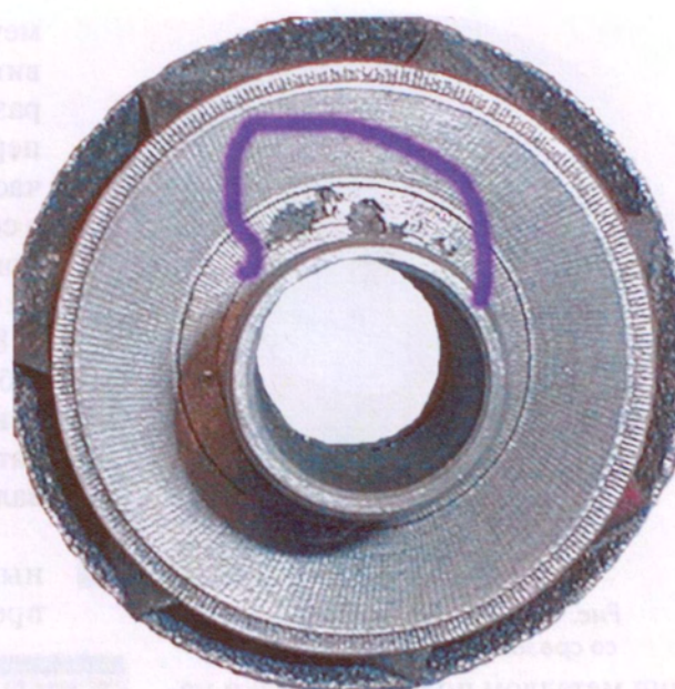
Рис. 11. Отливка рабочего органа 6 с окисленной, шероховатой раковиной в месте соединения стенок
