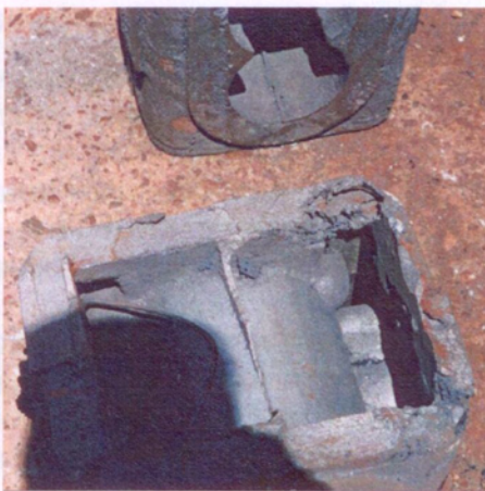
Рис. 8.5.4. Отливка «Корпус» с дефектом «Обжим»
