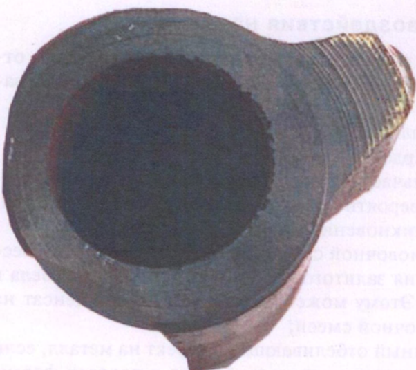
Рис. 9.2.5. Отливка «Корпус» с дефектом «Отбел»
