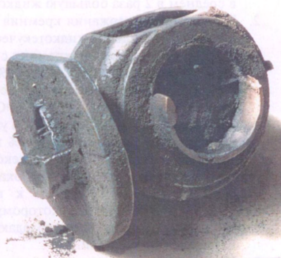
Рис. 6.2.1. Отливка «Корпус вентиля» с недоливом
