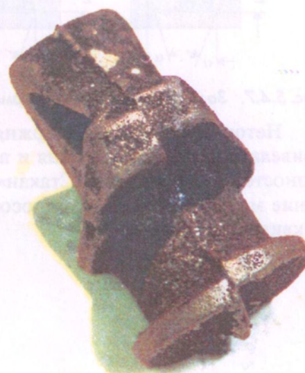
Рис. 5.4.11. Отливка «Наконечник» с дефектом «Смещение»
