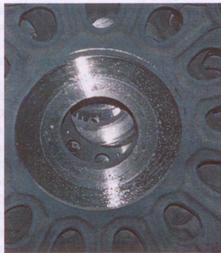
Рис. 3.3.2. Отливка «Колесо ведущее» с дефектом «Пористость»
