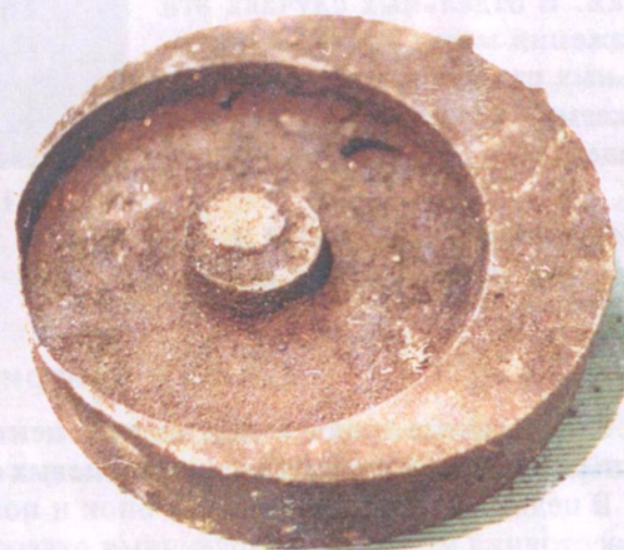
Рис. 5.3.9. Отливка «Каток» со смещенным болваном
