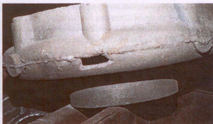
Рис. 5.2.3. Отливка «Корпус вала» с изломом тела отливки
