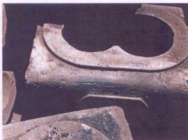
Рис. 6.1.4. Отливка «Корпус насоса» с «Неспаем»
