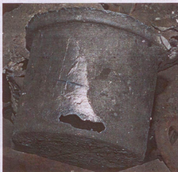
Рис. 5.3.3. Отливка «Стакан» с искажением размера и утонением стенок
