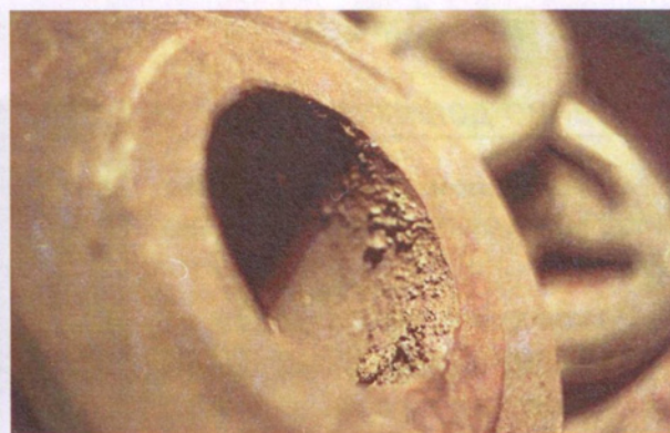
Рис. 5.3.8. Отливка «Корпус запорной арматуры» с искажением размеров
