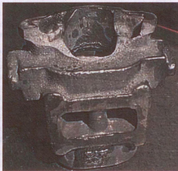
Рис. 5.2.1. Отливка «Цилиндр пускового двигателя» с механическим повреждением
