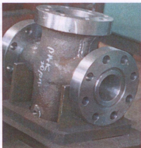
Рис. 4.2.2а. Отливка «Корпус запорный» со шлаковой раковинной на среднем фланце
