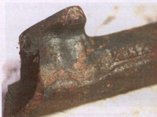
Рис. 5.2.2. Отливка «Патрубок всасывающий» с механическим изломом
