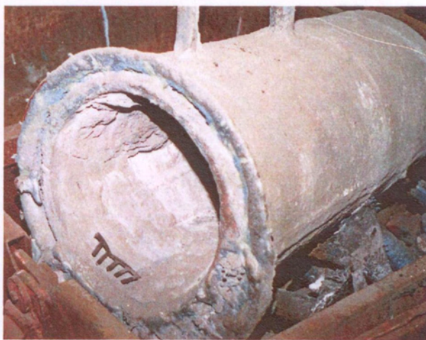
Рис. 6.2.13. Отливка «Тигель» с недоливом
