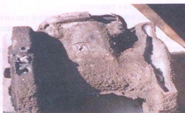
Рис. 6.2.3а. Отливка «Корпус вентиля» с дефектом «Уход металла»
