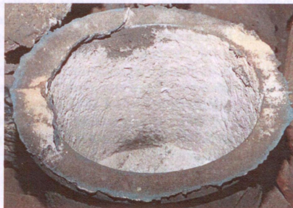
Рис. 5.4.8. Отливка «Стакан» с дефектом «Смещение»
