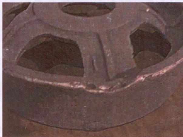
Рис. 5.2.6. Отливка «Колесо» с механическим повреждением
