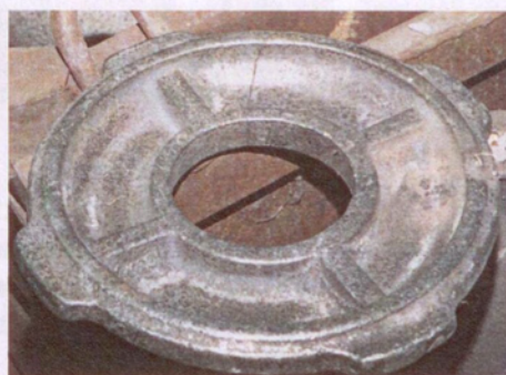
Рис. 5.2.8а. Отливка «Корпус» с холодной трещиной
