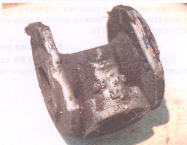
Рис. 6.2.12. Отливка «Корпус вентиля» с недоливом
