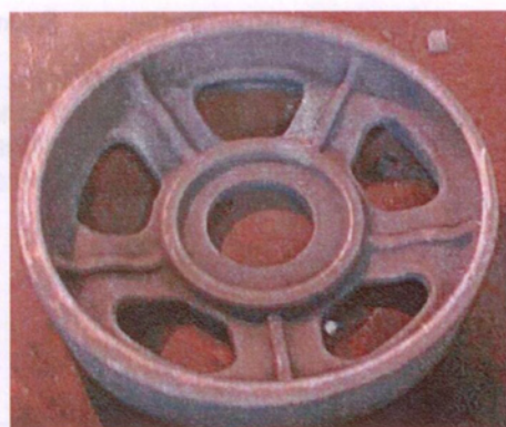
Рис. 5.4.9. Отливка «Колесо» с дефектом «Смещение»
