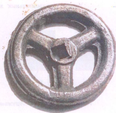
Рис. 5.4.10. Отливка «Маховик» с дефектом «Смещение»
