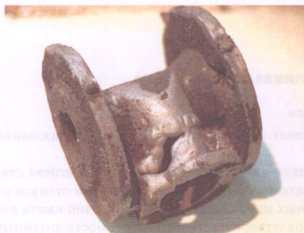
Рис. 6.1.2а. Отливка «Корпус вентиля» с дефектом «Неспай»
