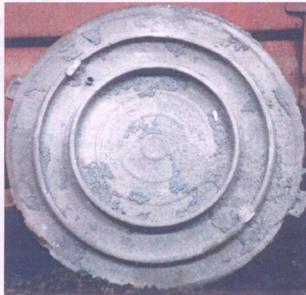
Рис. 7.1.2. Отливка «Крышка люка» с пригаром
