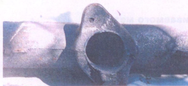
Рис. 4.2.3. Отливка «Коллектор» со шлаковой раковинной
