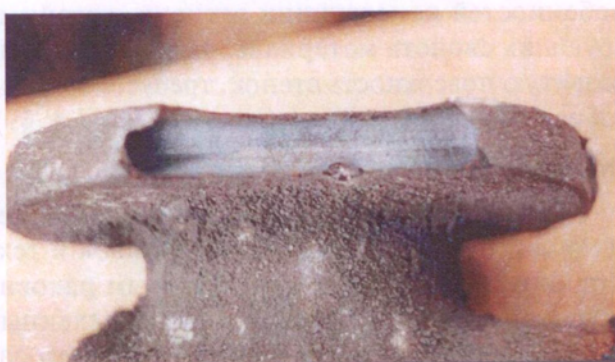
Рис. 6.2.3б. Фрагмент отливки «Корпус вентиля» с дефектом «Уход металла»
