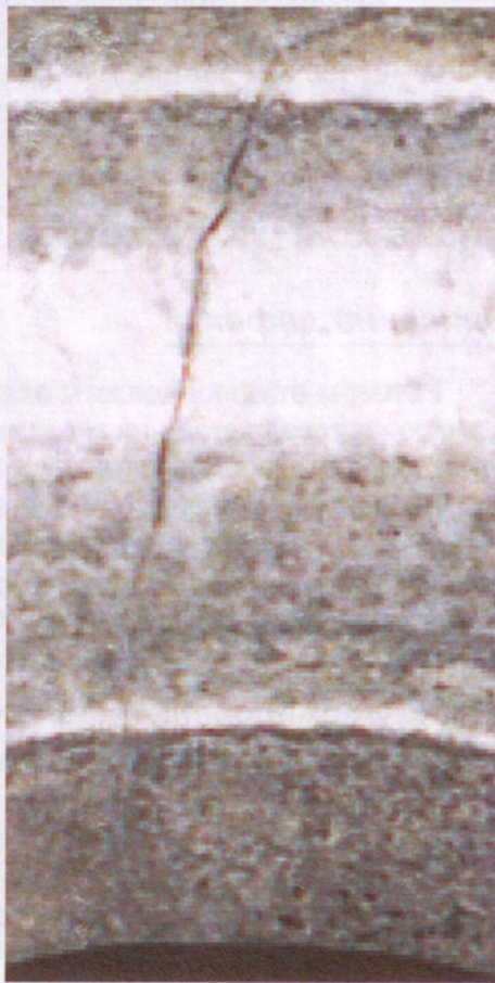
Рис. 5.2.8б. Фрагмент отливки с дефектом (увеличено)
