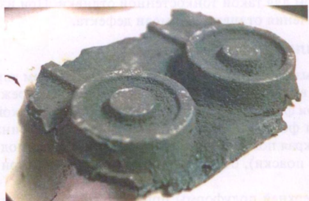
Рис. 6.2.4. Отливка «Каток» с уходом металла
