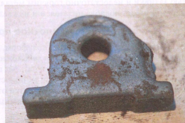
Рис. 6.2.5. Отливка «Опора» с дефектом «Недолив»
