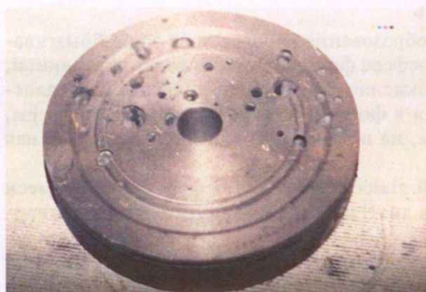
Рис. 4.1.4. Отливка «Фланец» с дефектом «Королек»
