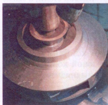
Рис. 1.1.5а Отливка «Колесо рабочее» с газовыми раковинами
