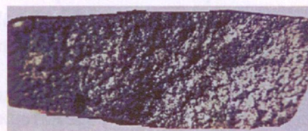
Рис. 2.1.20. Фрагмент поверхности трещин темно-серого цвета с коричневым налетом
