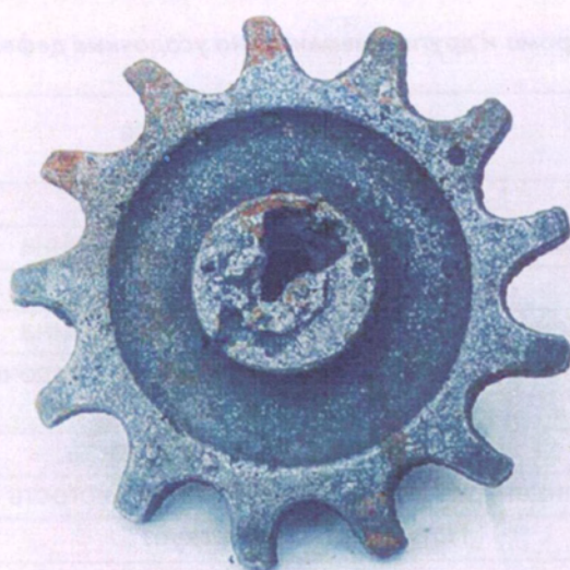
Рис. 3.1.7а. Отливка «Шестерня цепная» с усадочной раковиной
