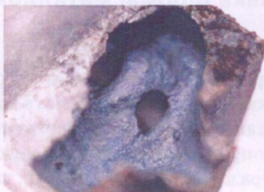
Рис. 1.7.6б. Дефект отливки (увеличено)
