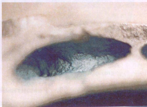
Рис. 1.8.3б. Фрагмент отливки с дефектом (увеличено)
