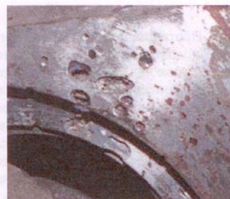
Рис. 1.1.4. Отливка «Цилиндр» с газовыми раковинами
