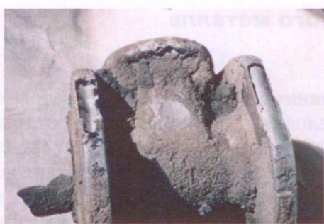
Рис. 1.7.2а. Отливка «Корпус задвижки» с газовой раковиной
