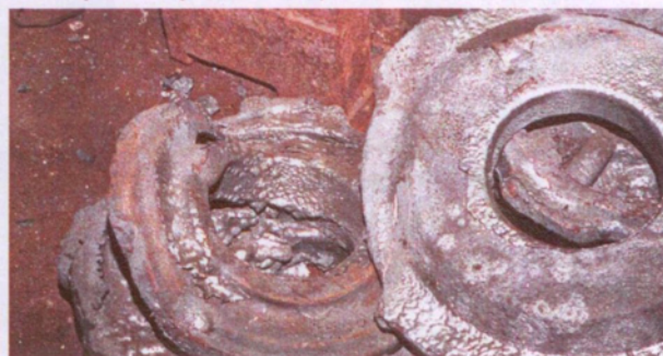
Рис. 2.2.5. Отливка «Кольцо» с деформацией и оплавлением отливки при термообработке
