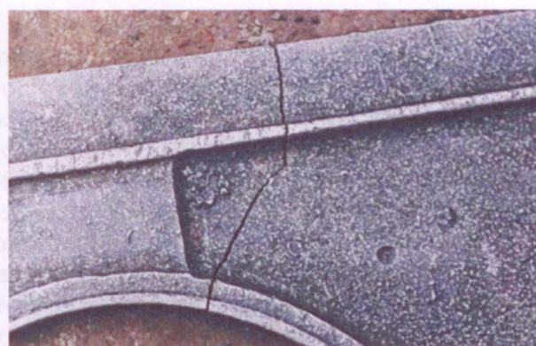
Рис. 2.3.3. Фрагмент отливки «Плита печная» с дефектом «Разрыв холодный»
