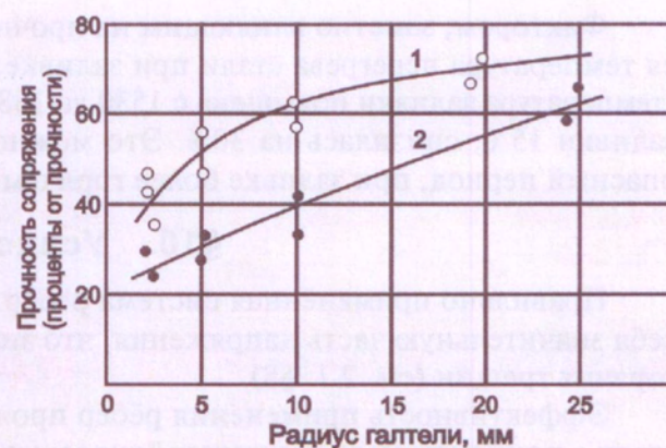
Рис. 2.4.10. Зависимость прочности образца с фланцем от радиуса закругления внутреннего угла сопряжения: 1 — толщина образца 15 мм; 2 — толщина образца 30 мм
