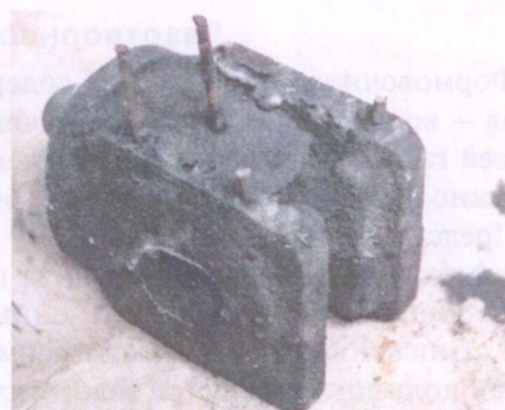
Рис. 1.7.12а. Отливка «Переходник» с газовым «пузырем подкорковым»
