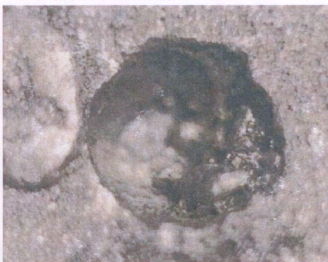
Рис. 1.6.1. Раковина шлакогазовая, сферической формы, окисленная, возможен желтоватый налет
