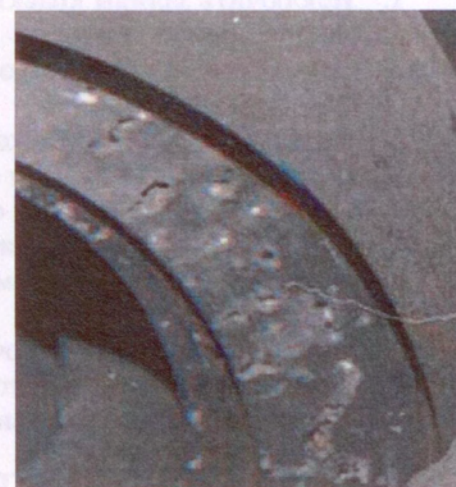
Рис. 1.1.6. Отливка «Корпус» с газовыми раковинами
