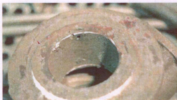
Рис. 1.4.15. Отливка «Корпус раздаточный» с окисленной газовой раковинной
