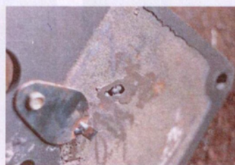
Рис. 1.2.9а Отливка «Задвижка печи» со светлой газовой раковинной
