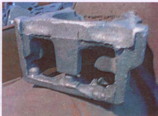
Рис. 1.2.3. Отливка «Корпус» с газовой раковиной («вскип»)
