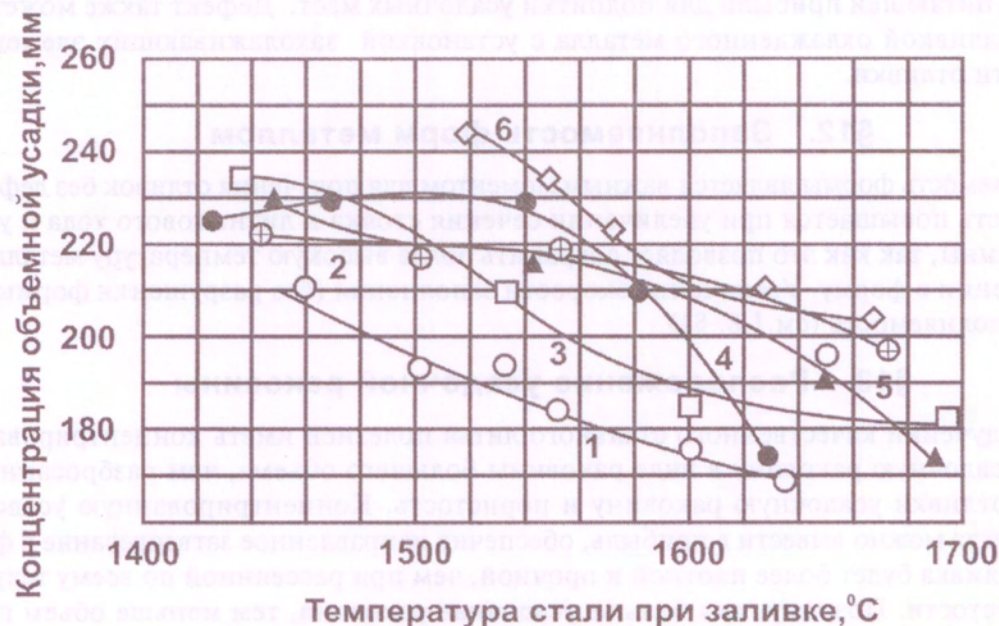
Рис. 3.1.12. Изменение концентрации объемной усадки в зависимости от перегрева при заливке сложнолегированных сплавов: 1 — X25H20; 2 — X25H5; 3 — 1X18H9T; 4 — X28; 5 — 1X16H15K3; 6 — 35Л
