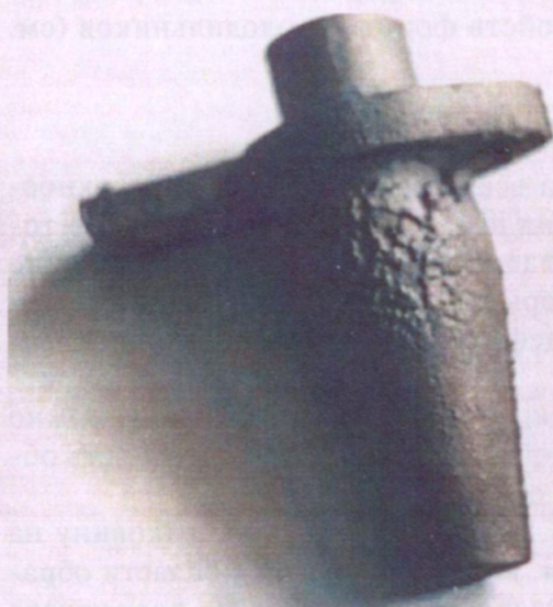
Рис. 3.1.4а. Отливка «Штырь» с усадкой
