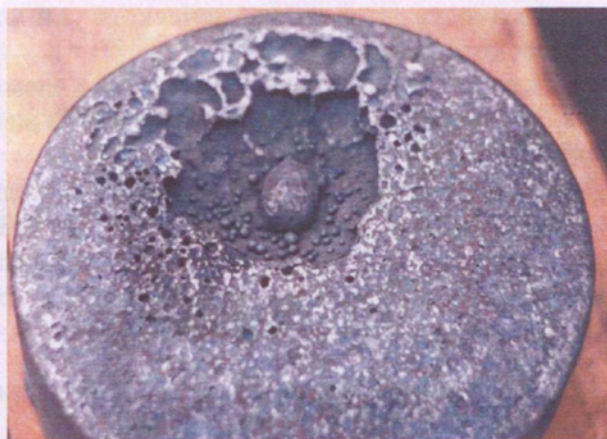
Рис. 3.1.3. Отливка «Диск» с открытой усадочной раковиной
