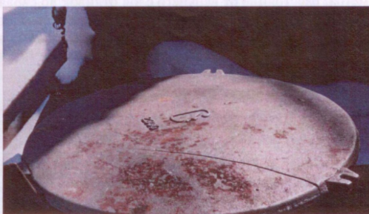
Рис. 2.3.1. Отливка «Крышка» с дефектом «Разрыв холодный»
