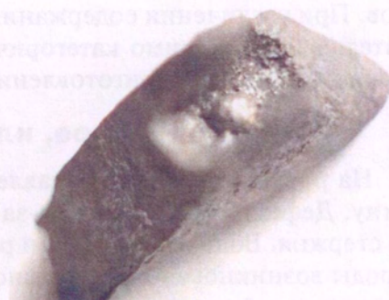
Рис. 1.2.7. Фрагмент отливки «Корпус» с газовой раковинной светлого вида
