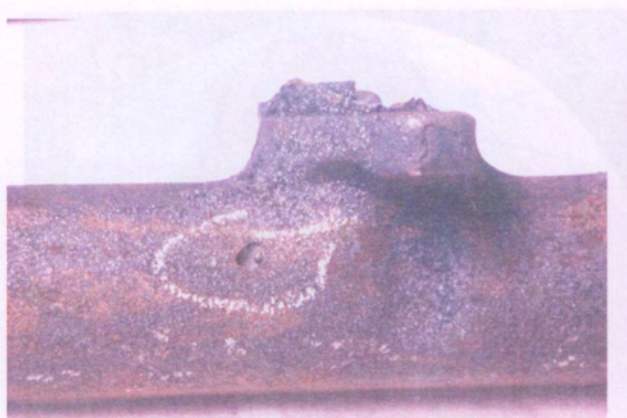
Рис. 1.4.9а. Отливка «Коллектор» с окисленной газовой раковиной
