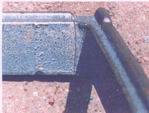
Рис. 2.1.21. Отливка «Корпус печной дверцы» с холодной трещиной
