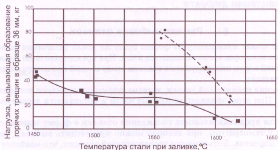
Рис. 2.4.20. Зависимость трещиностойкости стали к образованию горячих трещин от температуры при заливке: сплошная линия – 10X15H15K3ТЛ; прерывистая линия – 25Л
