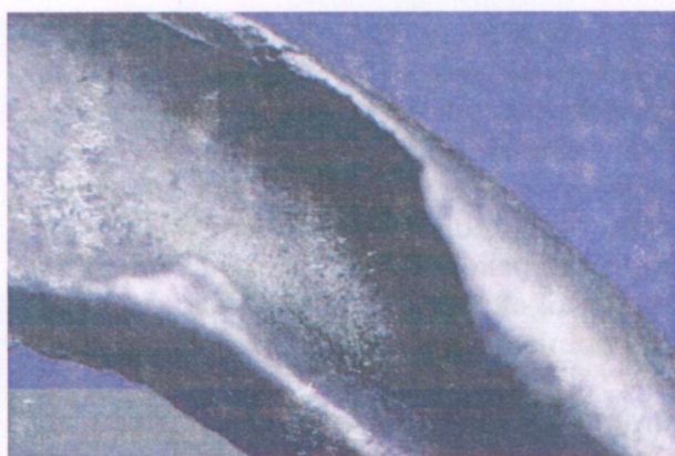
Рис. 1.7.8. Фрагмент отливки «Колесо маховое» с газовой раковиной
