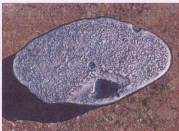
Рис. 3.1.2а. Отливка «Маховик» с открытой усадочной раковиной
