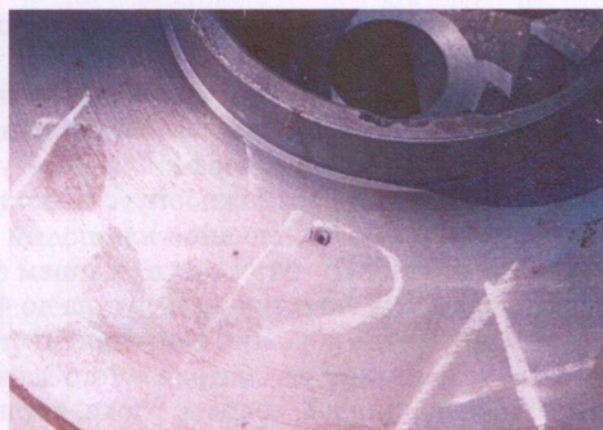
Рис. 3.2.10. Отливка «Колесо рабочее» с закрытой усадочной раковинной
