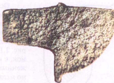
Рис. 2.1.17. Фрагмент поверхности трещины соломенно-желтого цвета
