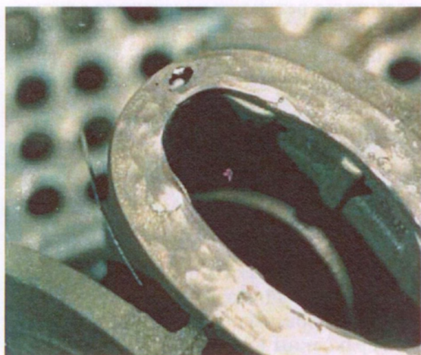
Рис. 1.2.14. Отливка «Корпус вентиля» со светлой газовой раковиной
