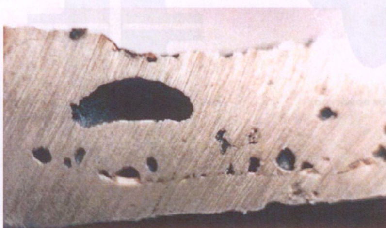
Рис. 1.4.3. Фрагмент отливки «Опора» с окисленными газовыми раковинами
