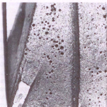
Рис. 1.3.2. Фрагмент отливки «Корпус» с подкорковой пористостью
