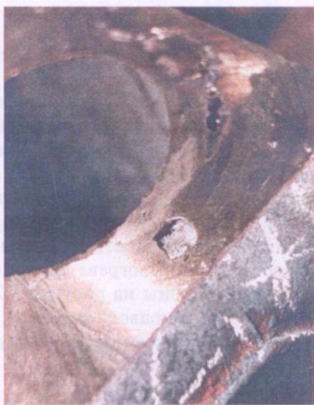
Рис. 3.2.6. Отливка «Корпус насоса» с закрытой усадочной раковиной
