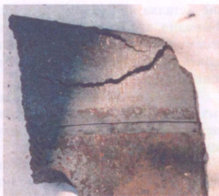
Рис. 2.2.3. Фрагмент отливки «Корпус горелки» с термической трещиной
