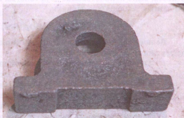
Рис. 3.1.10а. Отливка «Опора» с открытой усадочной раковиной
