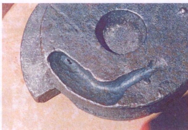
Рис. 1.8.4. Отливка «Фланец» с газоусадочной раковинной
