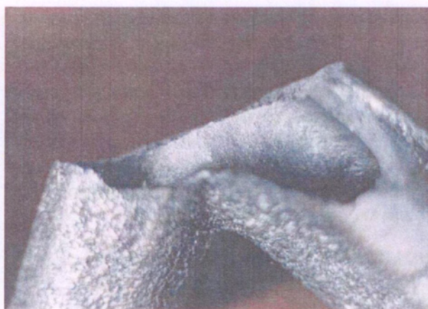
Рис. 1.2.4. Фрагмент отливки «Маховик вентиля» со светлой газовой раковинной
