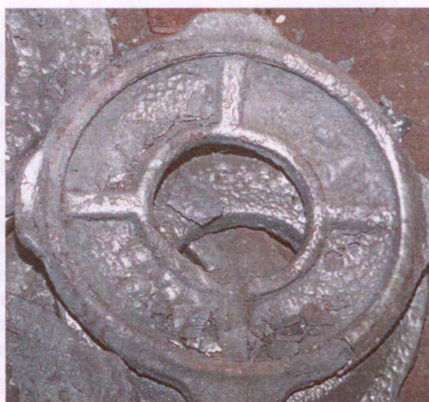
Рис. 2.2.4. Отливка «Крышка» с окалиной и мелкими термическими трещинами от повышенной температуры нагрева печи
