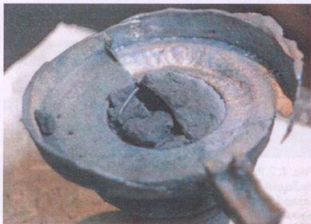
Рис. 1.2.2. Отливка «Фланец» с газовой раковиной, совместно с «утяжиной»
