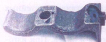
Рис. 1.7.6а. Отливка «Кронштейн» с газовой раковиной
