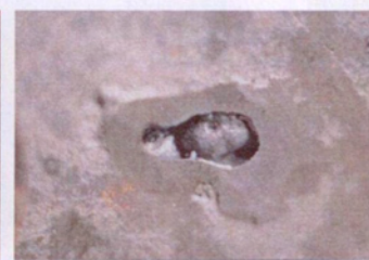
Рис. 1.2.9б Фрагмент отливки с дефектом (увеличено)
