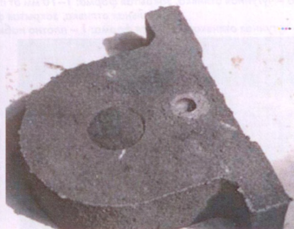
Рис. 1.4.18. Отливка «Опора» с газовой раковинной
