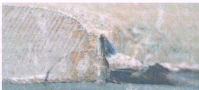
Рис. 2.1.9. Фрагмент отливки с неспаянным внутренним холодильником
