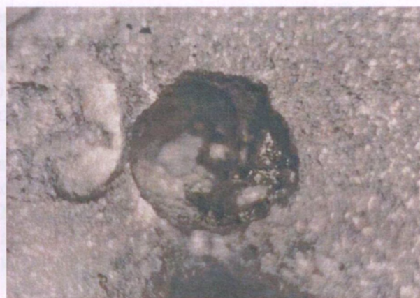
Рис. 1.6.10б. Дефект отливки (увеличено)
