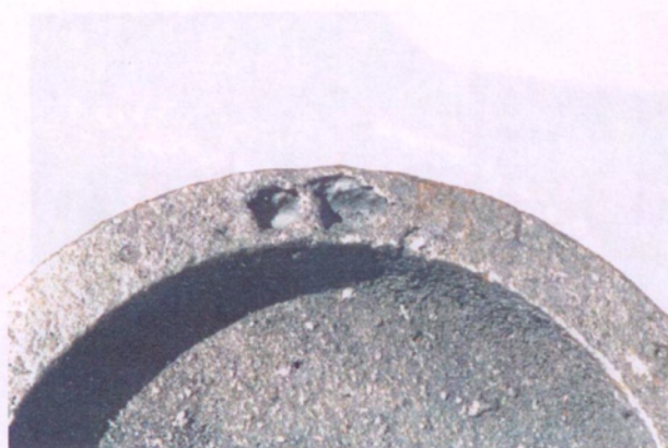
Рис. 1.4.13. Отливка «Корпус шестерни» с окисленной газовой раковинной
