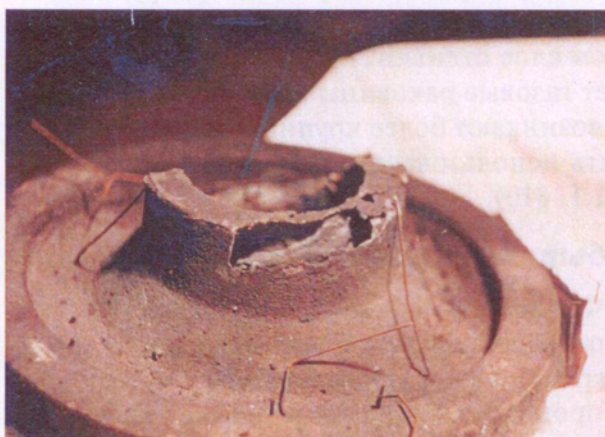
Рис. 1.2.6. Отливка «Колесо насоса» с газовой раковинной
