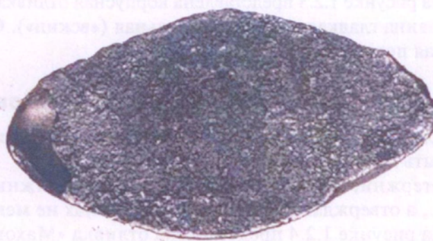
Рис. 1.2.1. Дефект отливки: раковина гладкая, светлая, локальная, более 6 мм, известна также как «вскип»
