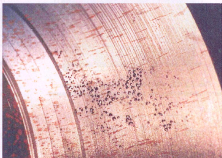
Рис. 1.3.1. Фрагмент отливки «Колесо рабочее» с дефектом «Пористость подкорковая»
