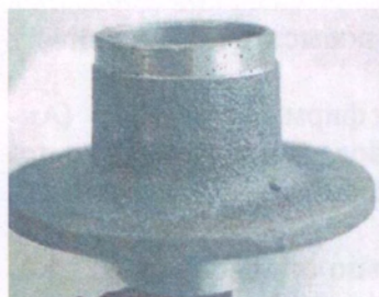
Рис. 1.1.3а Отливка «Фланец» с раковинной светлой, гладкой, рассредоточенной
