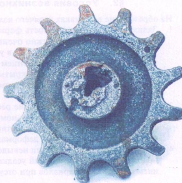
Рис. 3.1.1. Отливка «Шестерня цепная» с дефектом «Раковина усадочная открытая»
