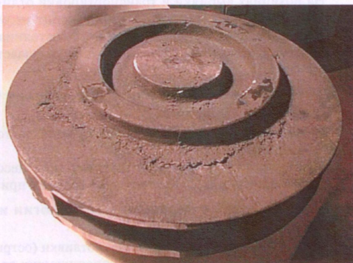
Рис. 2.4.1. Отливка «Рабочее колесо» с дефектом «Горячая трещина»
