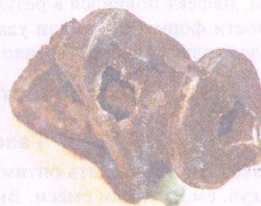
Рис. 1.7.10б. Отливка «Наконечник» с газовой раковиной
