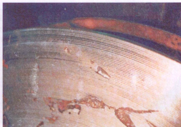
Рис. 1.8.5. Отливки «Колесо насоса» с газоусадочной раковинной
