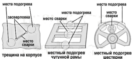
Рис. 23. Схема местного подогрева деталей под сварку
