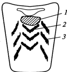
Рис. 22. Схема расположения ликвационных зон в литых заготовках:
