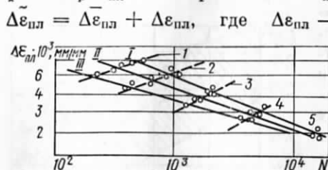
Рис. 103. Зависимость между пластической деформацией и числом теплосмен до разрушения стали 1Х18Н9Т при различных выдержках образца t_B при максимальной температуре и различных интервалах колебания температуры \Delta T :
