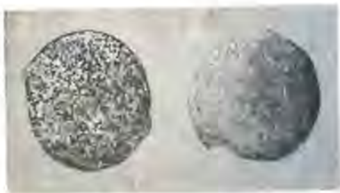
Рис. 54. Сплав АЛ8 до и после обработки фторцирконатом калия
