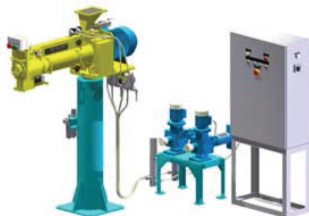
Рис. 2.28. Смеситель непрерывного действия модели С1ШЗ; http://belniilit050.narod.ru/SMESITEL1.html
