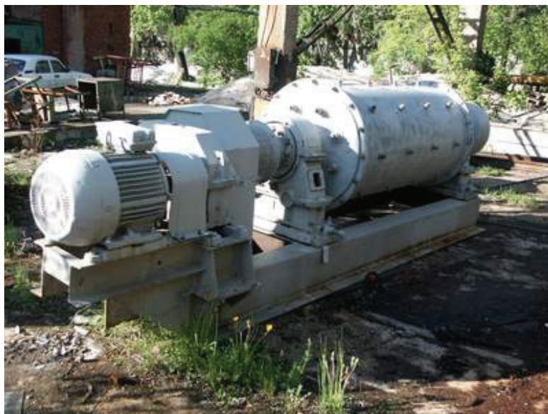
Рис. 1.9. Внешний вид мельниц шаровых моделей МШЦ 900×1800 (СМ6007А) и МШЦ 900×1800 (СМ6008А); agrobiznes.ru
