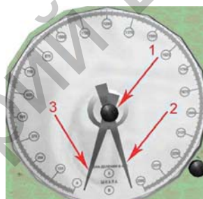
Рис. 2.14. Шкала динамографа: 1 – рукоятка управления пассивной стрелкой; 2 – активная стрелка (связана с замером); 3 – пассивная стрелка
