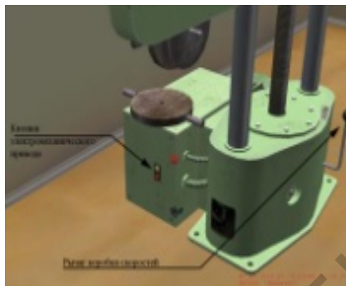
Рис. 2.12. Кнопки электромеханического привода и рычаг коробки скоростей
