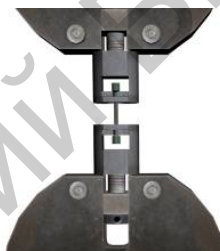
Рис. 2.11. Зажатый между кулачками образец
