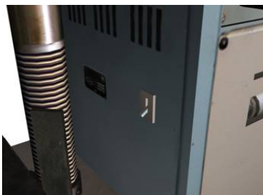
Рис. 3.9. Тумблер включения сети
