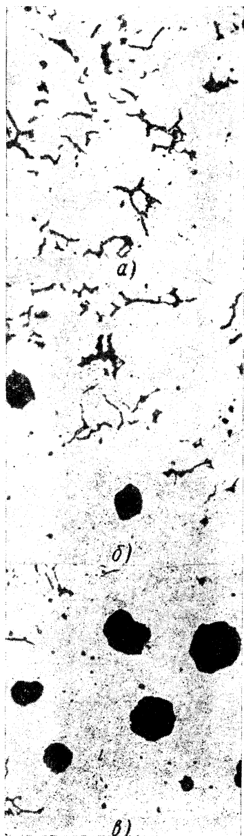
Фиг. 52. Форма графита в отливке, залитой чугуном с применением вставок из экзотермических смесей.
