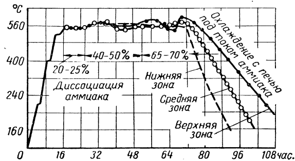
Фиг. 109. Режим азотирования крупных коленчатых валов.
