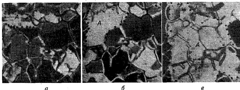
Рис. 7.7. Образование крупного зерна при рекристаллизации нихрома после деформации на \epsilon_{кр} :
