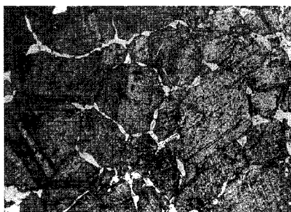
Рис. 13.5. Микроструктура феррита с примесью, образующей легкоплавкую эвтектику, после жидкофазного спекания и охлаждения
