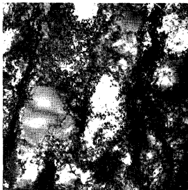
Рис. 3.9. Ячеистая дислокационная структура в сплаве Ni—Cr ( \times 2500 )
