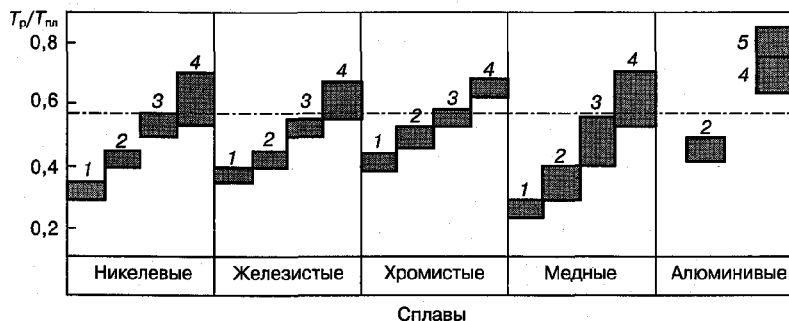
Рис. 5.11. Относительные температурные уровни рекристаллизации металлов и сплавов на их основе:
