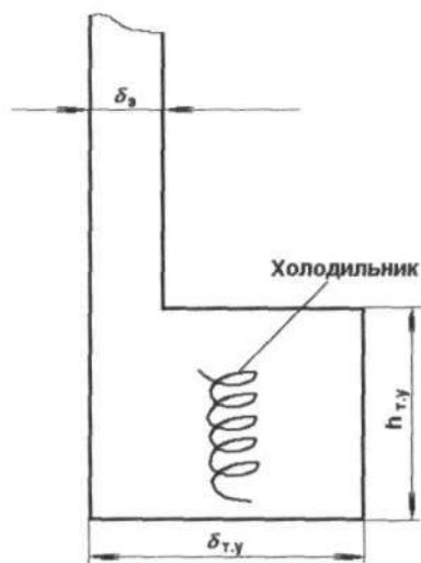
Рис. 4.11. Схема для расчета массы внутреннего холодильника
