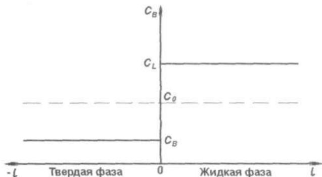
Рис. 3.19. Распределение концентрации по длине жидкой и твердой фаз при малой скорости кристаллизации ( k_0 < 1 )
