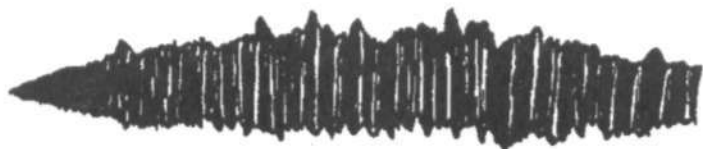
Рис. 3.29. Вид дендрита, извлеченного из прибыли стального слитка
