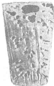
Рис. 6.3. Газовые раковины, образованные в результате выделения водорода из стали
