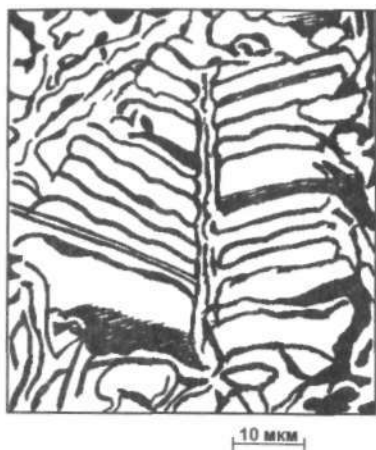
Рис. 3.41. Пример сложнерегулярной эвтектической структуры
