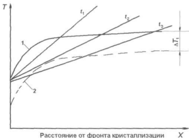
Рис. 3.47. Распределение температур перед фронтом кристаллизации ( t_3 > t_2 > t_1 )
