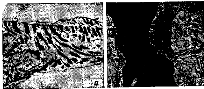
Рис. 57. Цементито-силикокарбидный эвтектоид (а — \times 150 , тепловое травление) и два типа перлита (б — \times 600 ) в чугуне с 4,9% Si
