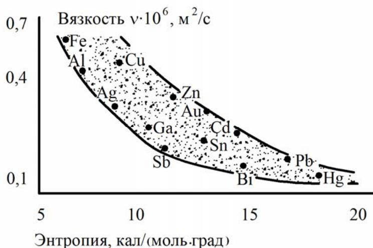
Рис. 1.6. Соотношение между вязкостью жидких металлов и стандартным значением их энтропии
