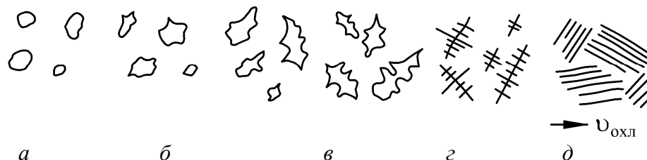
Рис. 9.13. Зависимость формы кристаллов от скорости охлаждения расплава
