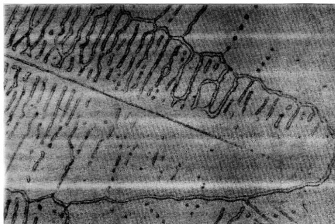
Рис. 11.7. Сегрегация в алюминий-медном сплаве
