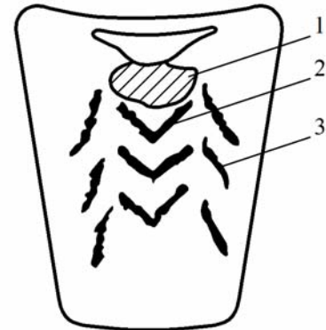
Рис. 11.9. Схема расположения ликвационных дефектов в отливке: 1 — ликвационное пятно; 2 — осевая V-образная ликвация; 3 — внеосевая Λ-образная ликвация
