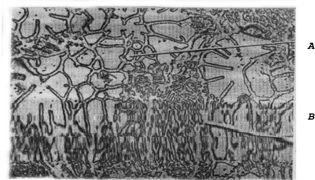
Рис. 10.8. Равноосные зерна в слитке алюминиевого сплава с 2 % Cu:
