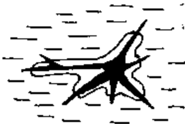
Рис. 4.10. Схема формирования аустенитно-графитной эвтектической колонии
