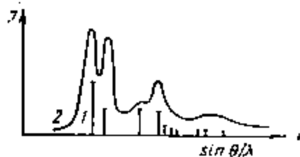
Рис. 1.1 Схема рентгенографических спектров твердого (1) и жидкого (2) металла. (Изменение интенсивности I в функции радиального распределения \sin \theta/\lambda )
