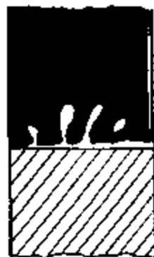
Рис. 2.13. Газовые раковины экзогенного характера, «ситовидная пористость»
