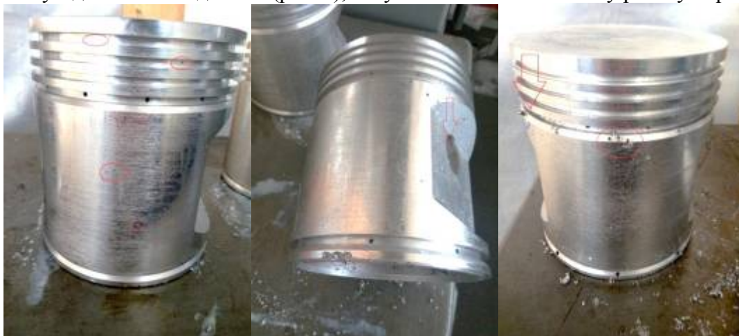
Рис.1. Дефекти у вигляді газоусадкових раковин на оброблених виливках поршнів
