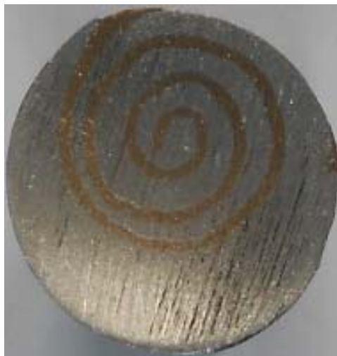
Рис. 1. Рабочая поверхность образца для испытаний на износ (Ø10 мм)
