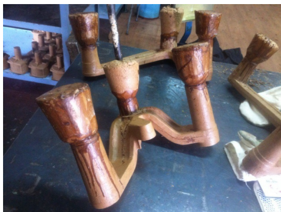
Рис. 2. Експериментальна модель виливка «Вагіль рульової тяги» до БТР-ЗДА
