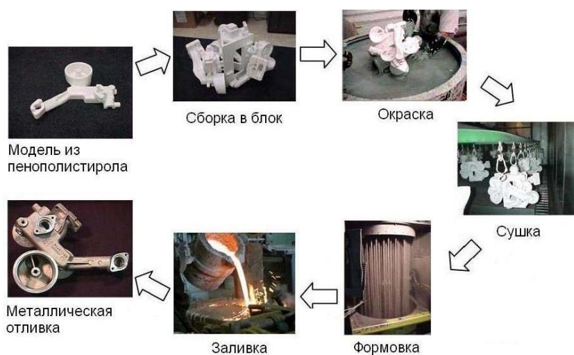
Рис. 2. Последовательность операций ЛГМ-процесса в фотографиях
